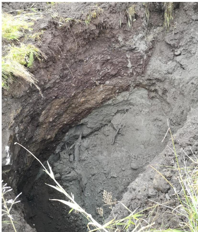
Figur 6. Prøvegravingen viste at deponiet besto av masser av varierende art.
