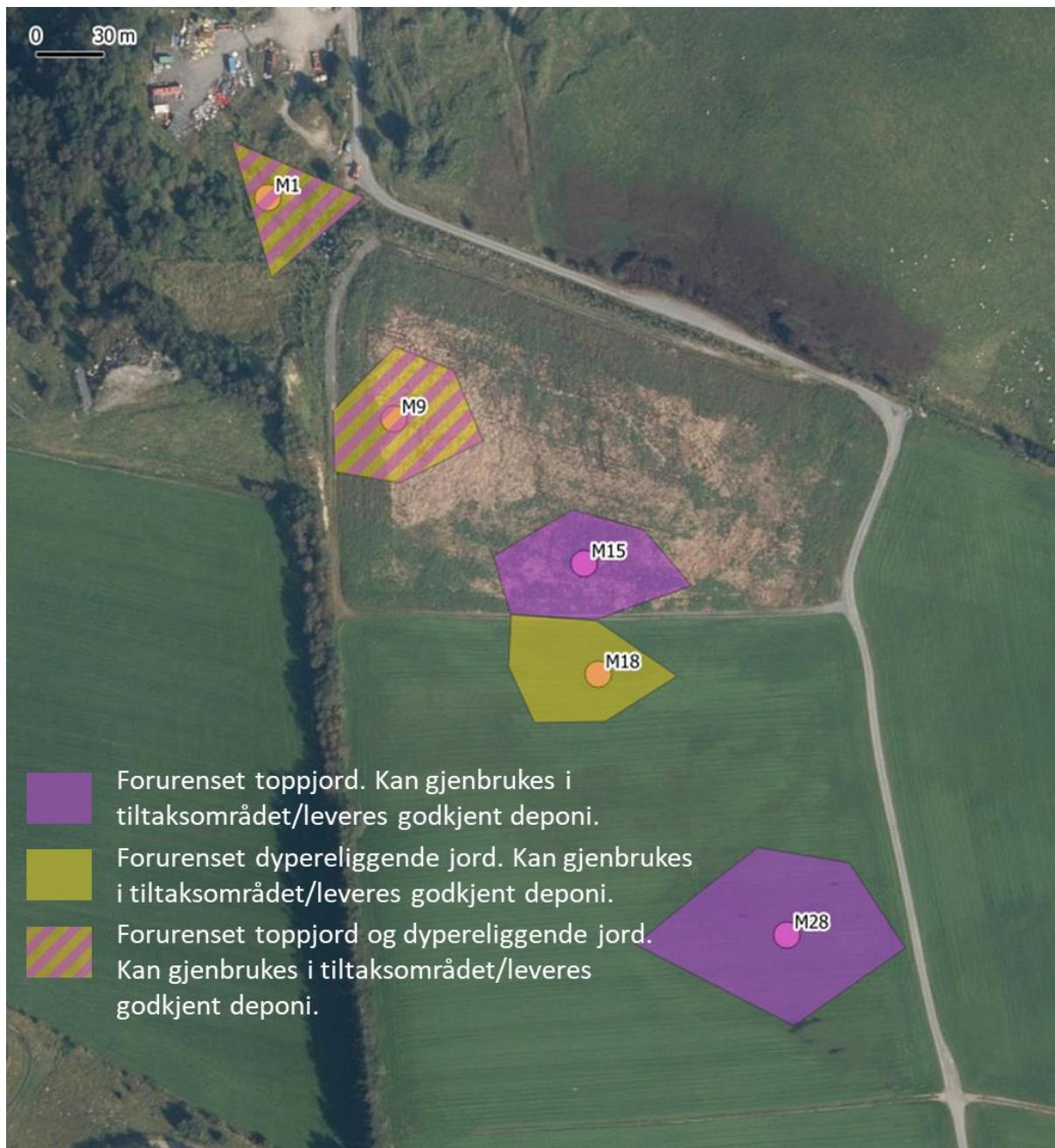
Figur 9. Graveplan og massehåndtering for gravearbeider ved bygging av datalagringspark på Kalberg i Time kommune. Merk at figuren viser kun massehåndtering for påvist forurensning. Øvrige prøvetatte masser er klassifisert som rene. Figuren ses i sammenheng med figur 10 som viser forurensningens vertikale fordeling.
